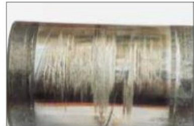
Sl. 7.27. Nagrizanje valjčica lanca
