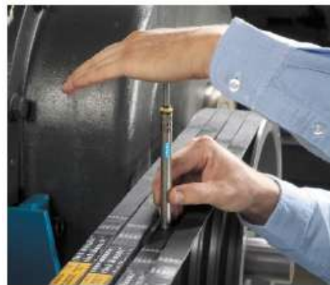
Sl. 8.28. Kontaktno merenje ugiba pomoću olovke
